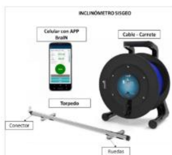
Figura 2. Equipo de medición marca Sisgeo
