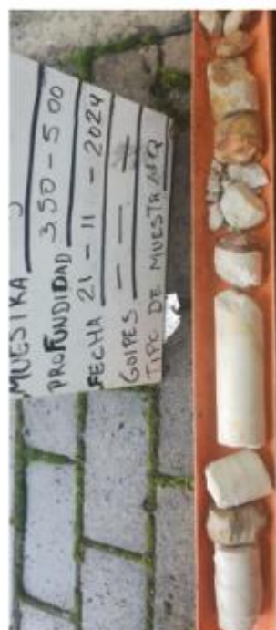
Fotografía 4-2 Recuperación de muestras con barrena
