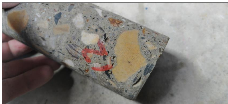
Fotografía 3. Núcleo #12 f_c=11 MPa
