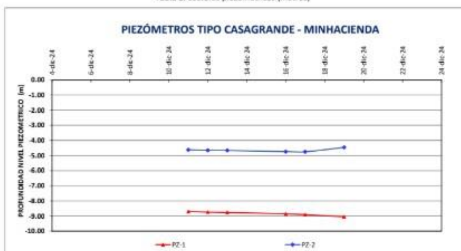
Figura 8. Lecturas de referencia Piezómetros tipo Casagrande
