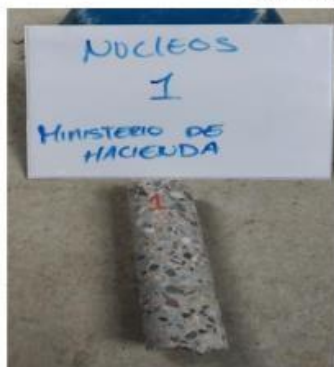
Foto No. 1 Referencia: Eje (H-5) Núcleo para ensayo de carbonatación
