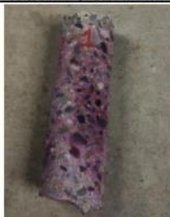
Foto No. 3 Referencia: Eje (H-5) Núcleo impregnado de Fenolftaleína
