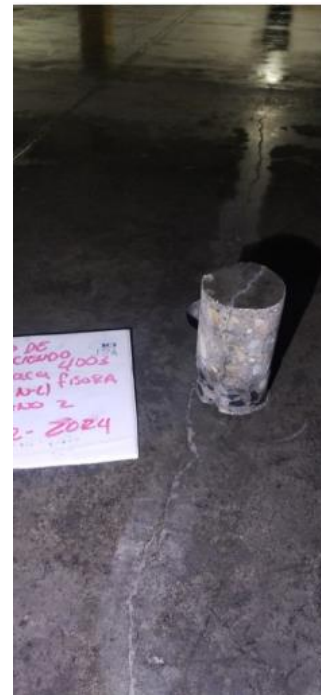
Fotografía 1. Espesor de placa 12cm, la fisura atraviesa todo el espesor.
