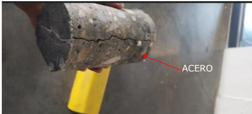
Fotografía 1. Espesor de placa 12cm, la fisura atraviesa todo el espesor.
