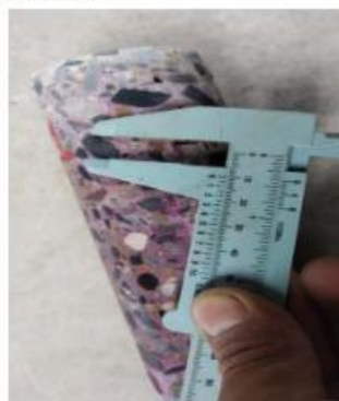
Foto No. 2 Referencia: Eje (H-5) Medición del tamaño máximo del agregado
