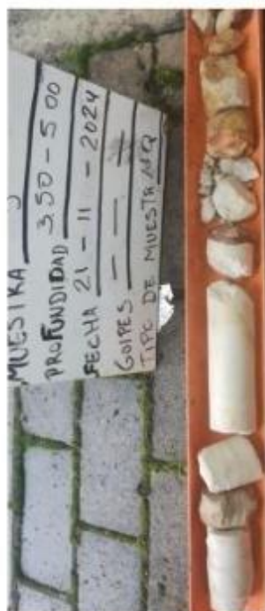
Fotografía 4-2 Recuperación de muestras con barrena
