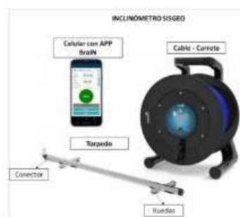
Figura 2. Equipo de medición marca Sisgeo
