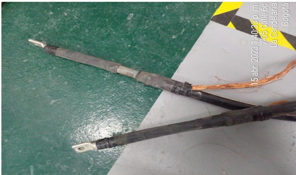
Descripción: Cambio premoldeado dañado de alimentador.
