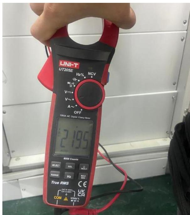
Descripción: Resultado prueba pinza amperimétrica, tablero principal zona transferencia.
