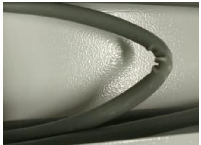
Daño por curvatura en canaleta
