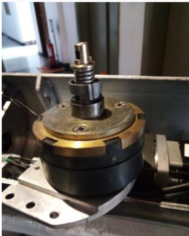
Ensamble y ajuste de pieza en solenoide
