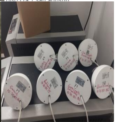
Todas las cámaras están quedando marcadas en la base con la información del área de desmonte y la dirección IP.
