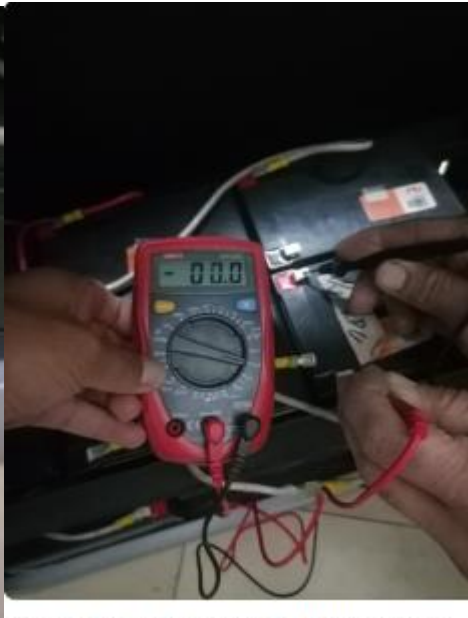
Se realiza medición de baterías de encuentran sin carga
