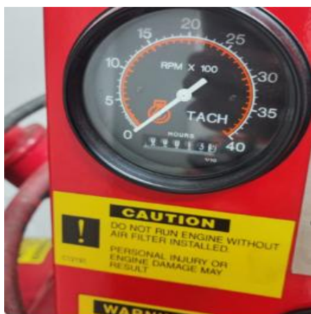
Número de horas de funcionamiento bomba diesel San Agustín (139 h)
