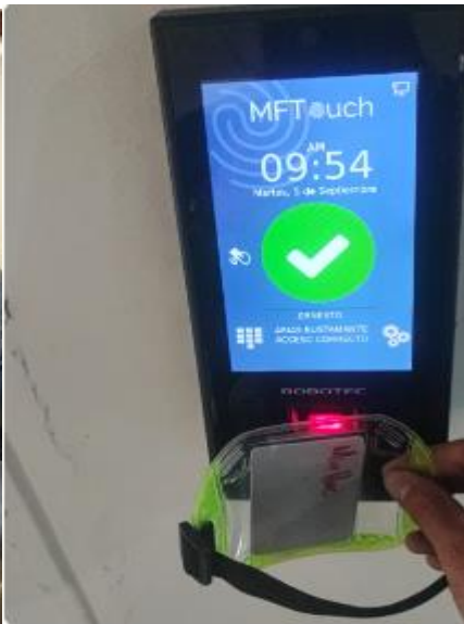
Lectora de salida operativa con tarjeta y huella
