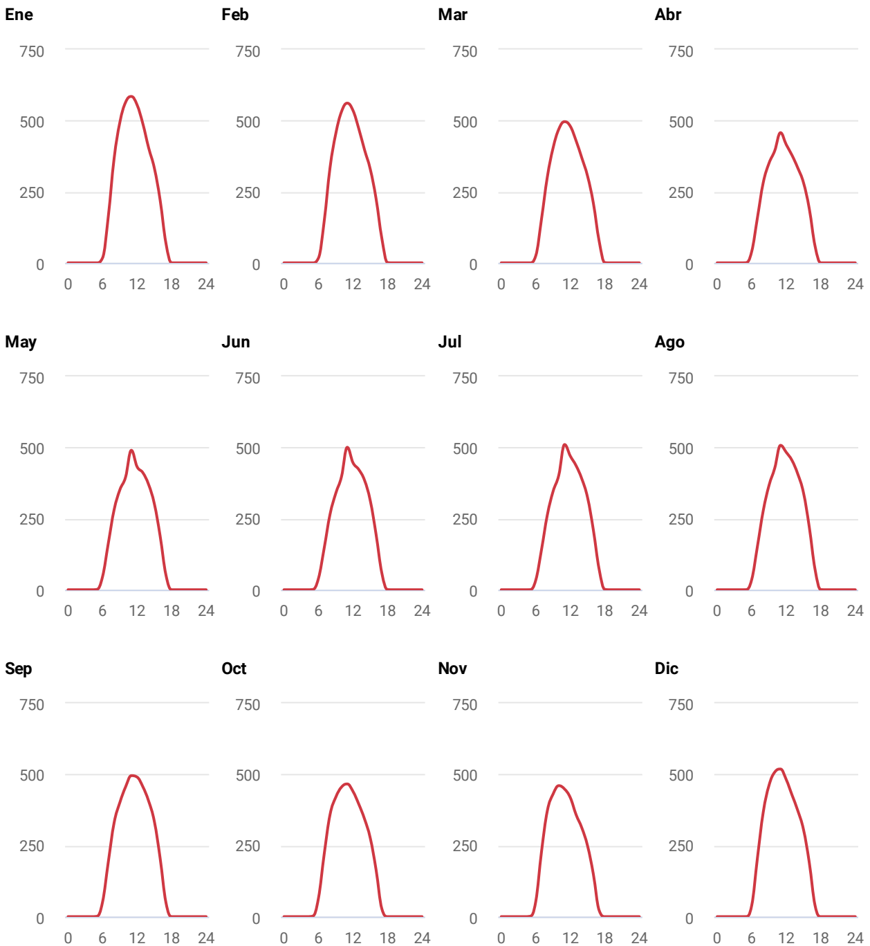
Figura 6.1: Producción eléctrica fotovoltaica específica – promedios horarios
